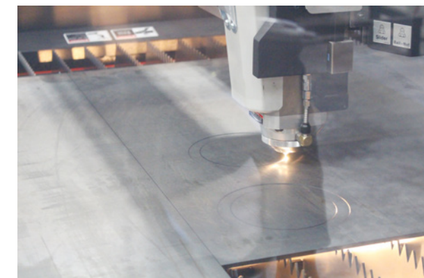
Entre las capacidades de Tenere, se encuentra el cortar acero de hasta 3/4 de grosor en un lapso muy corto de tiempo.
